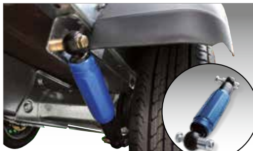
Radstoßdämpfer (montiert) inkl. 100 km/h Bestätigung Radstoßdämpfer (lose) ohne 100 km/h Bestätigung
